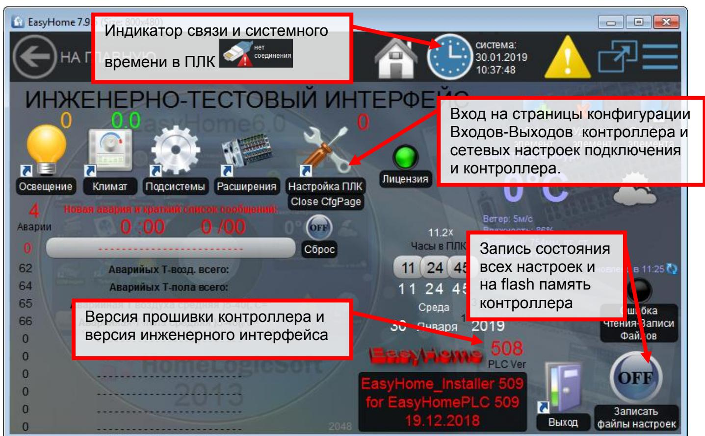
Рисунок 2 – главное окно инженерного интерфейса **EH\_Installer\_509**
