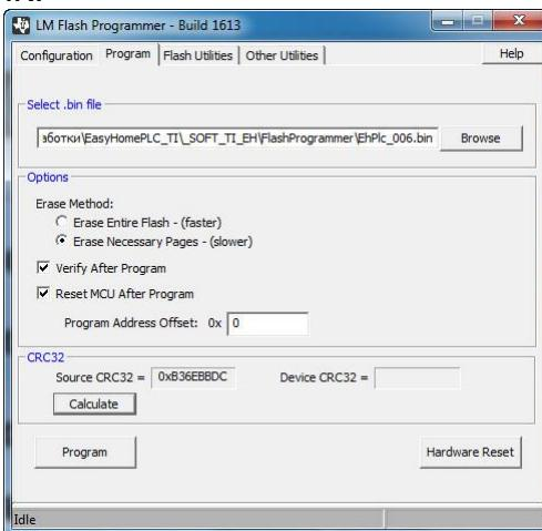
8. Индикация процесса и сообщение о завершении прошивки и успешной верификации будет в нижней части окна в статусной строке:
