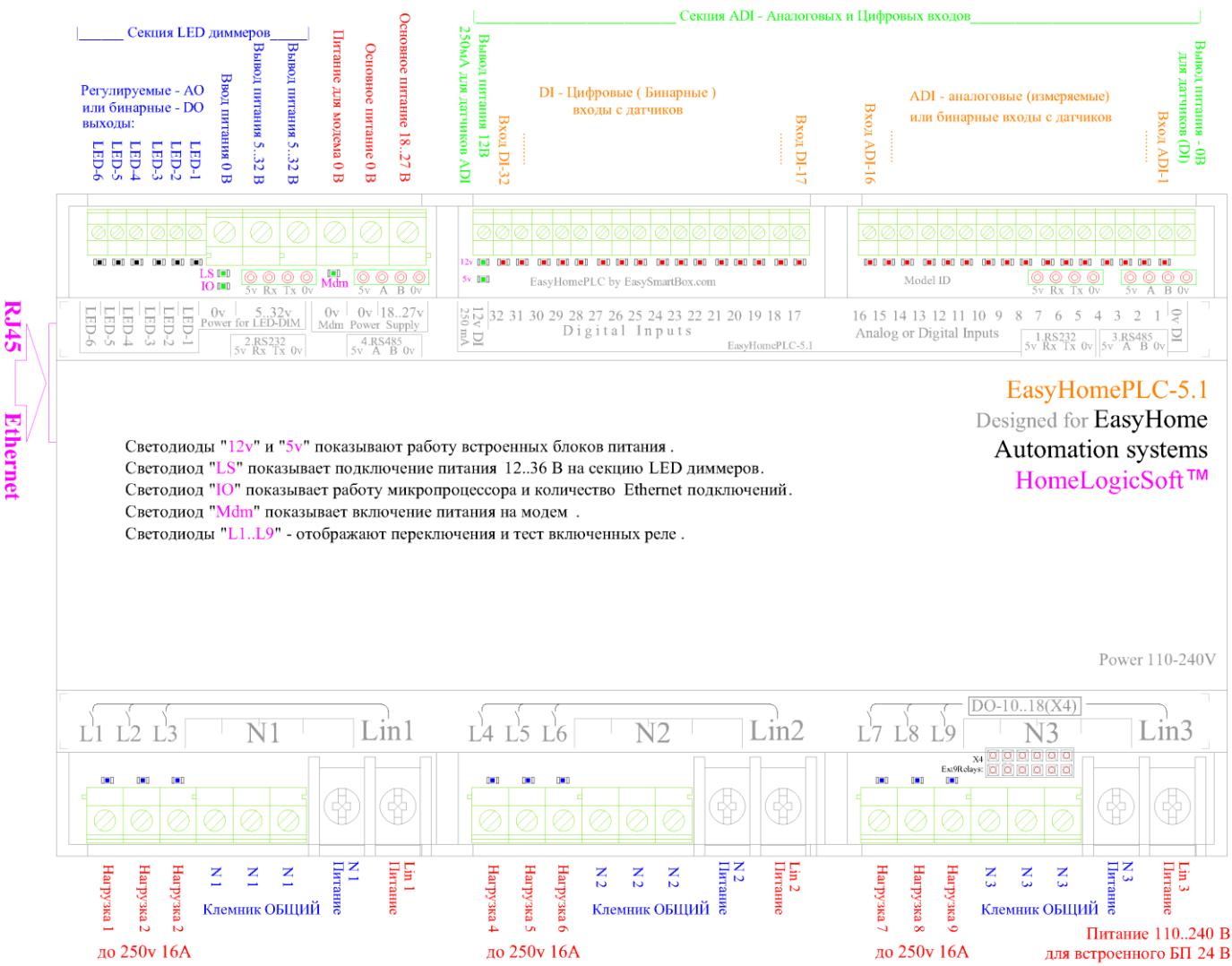
Рисунок 1 – клеммы контроллера
