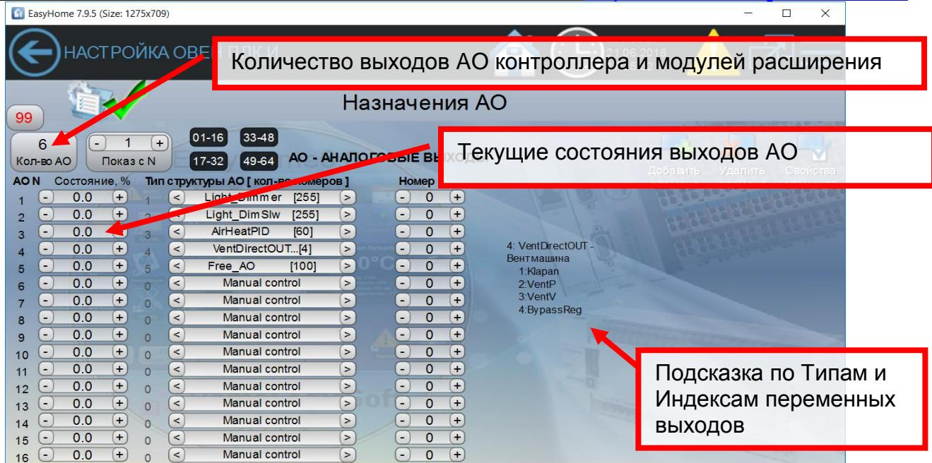
Рисунок 11 – настройка аналоговых выходов контроллера
