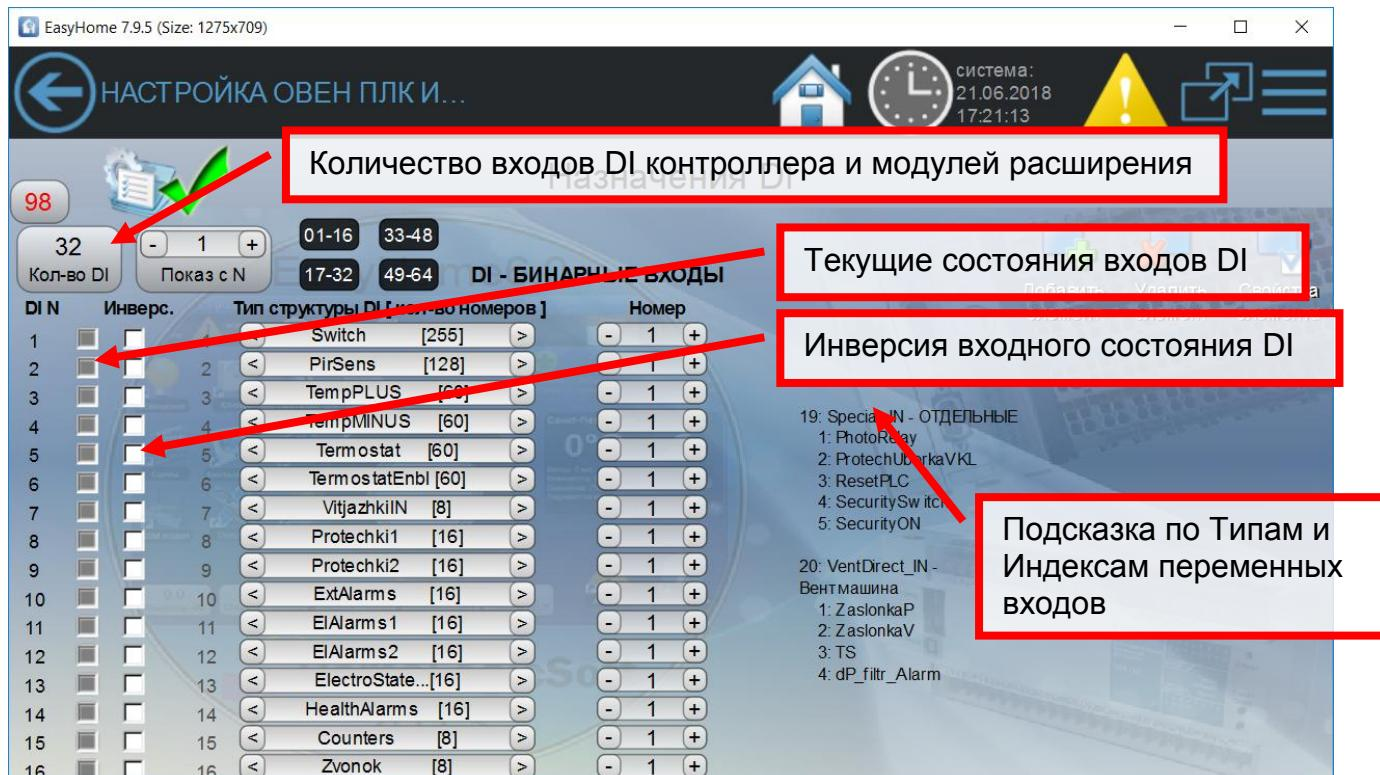
Рисунок 8 – настройка дискретных входов контроллера
